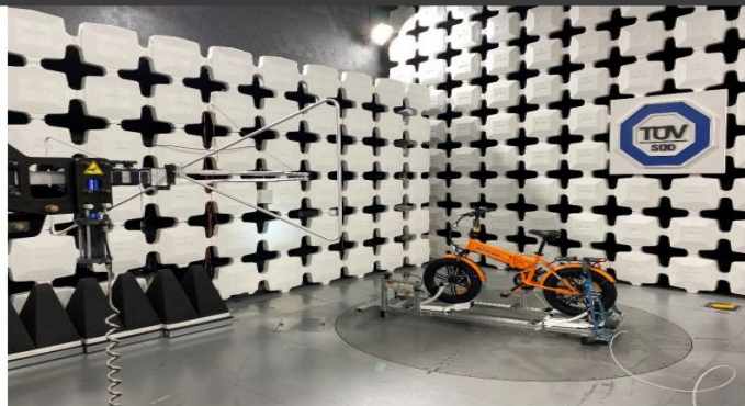
Figura 1 – Lato sinistro – Trilog antenna polarizzazione orizzontale
